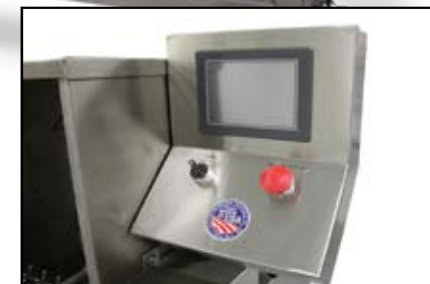
ABR Touch Screen Controls
